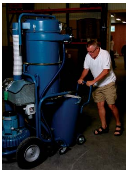
Pour vidanger le conteneur, le détacher et l'enlever de dessous la machine. Après que cela ai été effectué, le sac plastique peut être enlevé du conteneur.
