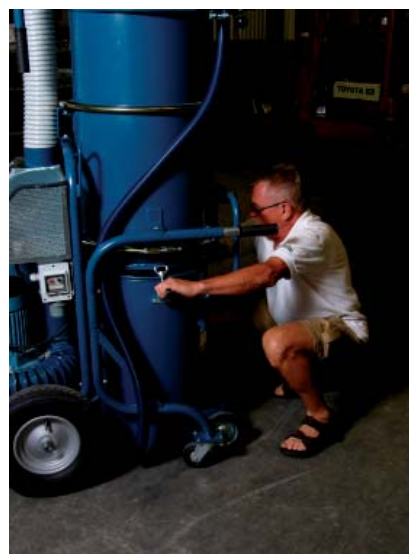
Le conteneur est attaché à la machine par deux crochets.
