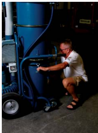
Behållaren sätts fast på maskinen med hjälp av de båda spärrlåsen.
